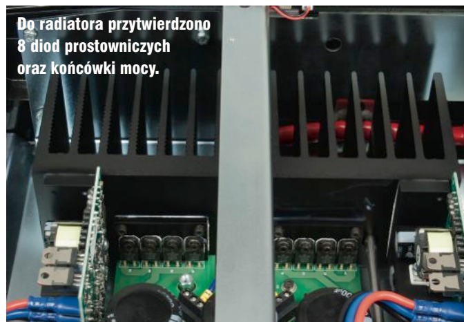
Moduł końcówki mocy jednego kanału. Tranzystory pracują w trybie przełączanym.
