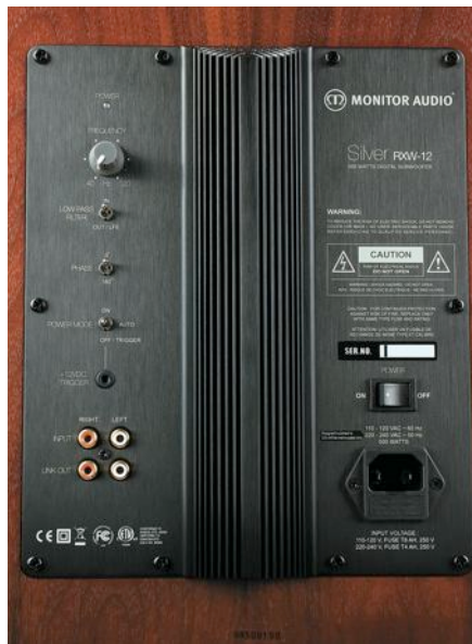
Tablicę rozdzielczą wykonano z grubej aluminiowej płyty.
