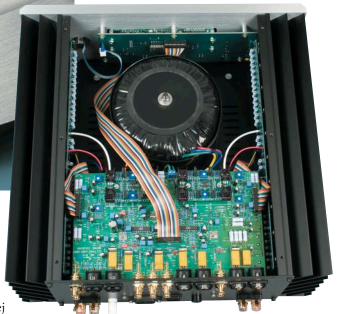
Ogromny toroid. Reszta zasilania pod płytką przedwzmacniacza.
